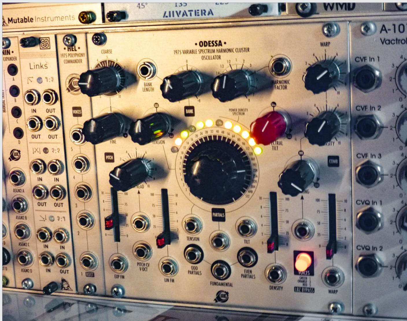
fall rascher (ähnlich Dreieck bis zu Sinus-schwingung der Grundfrequenz), rechts verschwindet der Abfall zunehmend, was bei Verwendung der ungeraden Obertöne einer Rechteckschwingung ähneln kann. Dem roten Knopf links gegenüber steht der Parameter **Tension**, mit dem man die Frequenzverhältnisse zwischen den Partialen steuert. In Mittelstellung sind die Frequenzverhältnisse ganzzahlig, was der harmonischen Obertonreihe entspricht.
