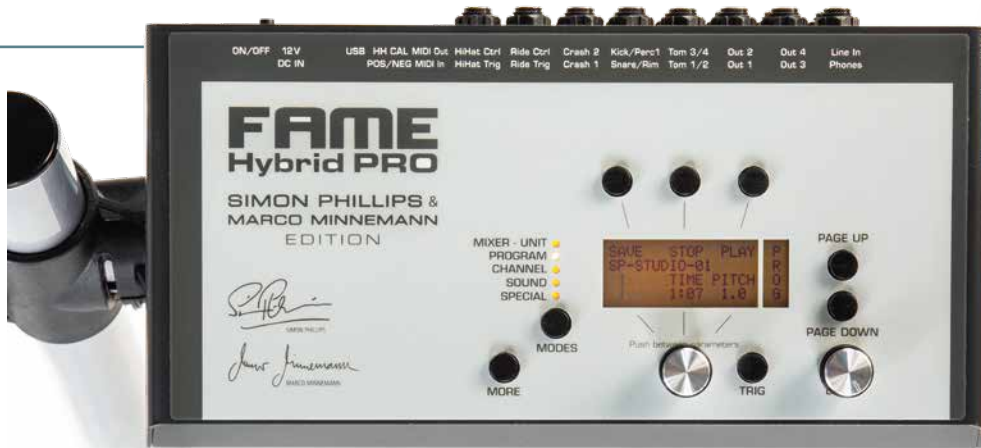
▲ Gut lesbar und beleuchtet: das Display, unterteilt in sechs Bereiche, die mit drei Tastern und einem Drehregler gesteuert werden
